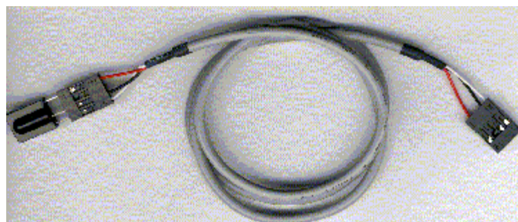
Capteur -- Câble 2 conducteurs + masse -- Vers Connecteur U6
