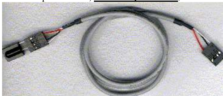
Capteur -- Câble 2 conducteurs + masse -- Vers Connecteur « IFR »
