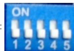
Par défaut, la carte **PI-FX/X4** est livrée en configuration « **AUTO** » (DIPSW **S1/S2/S3** = OFF) : la carte principale **PI-1 X4** configure automatiquement la carte **PI-FX/X4** avec le jeu sélectionné s'il est dans la liste suivante : **Totem, Hulk, Genie, Buck Rogers, Torch, Roller Disco, Asteroid Annie**. Il est également possible de changer manuellement cette configuration, même flipper allumé, à l'aide des DIPSW **S1/S2/S3**.
